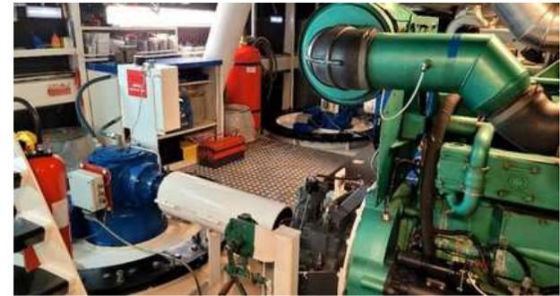
La propulsion est assurée par trois ensembles, chacun constitué d'un moteur diesel Cummins de 630 ch. entraînant un propulseur azimutal Schottel dont l'orientation est contrôlée depuis la "Marquise".
